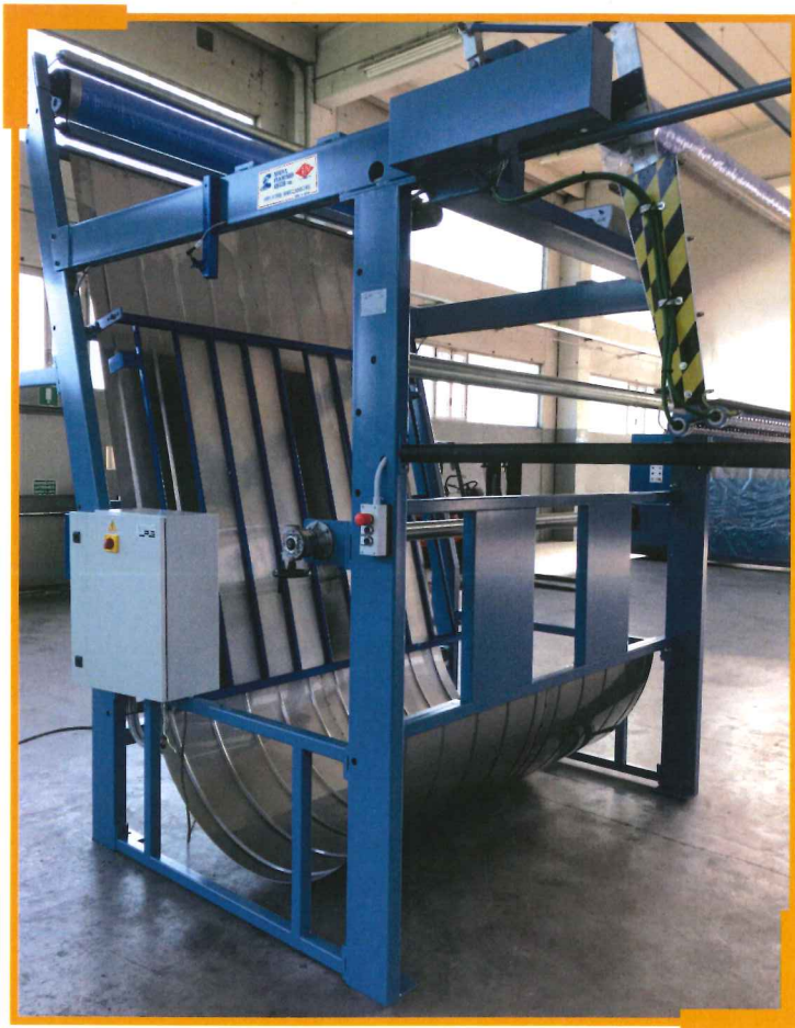
Linea di faldatura LF1 Preparation line in lap LF1
